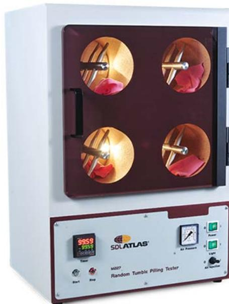
ASTM D3512 試験規格の長年の標準機器である SDLAtlas Random Tumble Pilling Tester は、何十年にもわたって一貫性のあるピリングテストを提供してきました。
