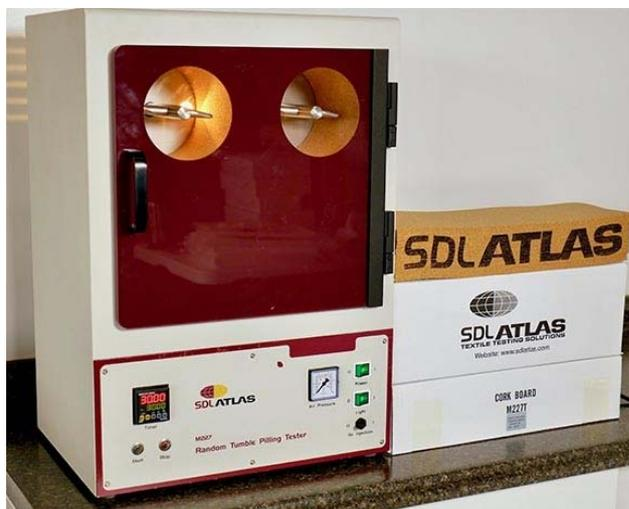
ASTM D3512 に準拠したインペラー(羽根)が同梱されています。
