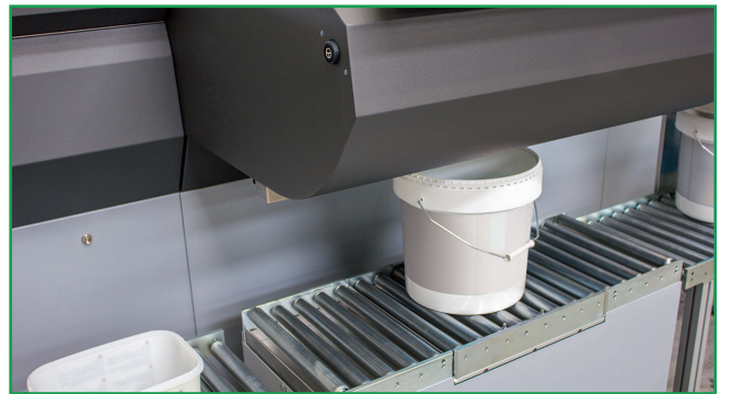
調整可能で自動化されたローラーコンベヤーにより、ユーザーフレンドリーで人間工学に基づいた缶のフローを実現します。
