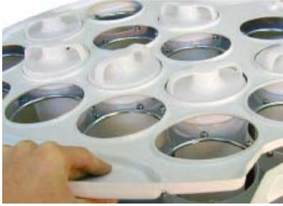
上部プラスチックカバーを脱着し、簡単に洗浄できるので、原色充填時に原色をこぼしてもすぐにクリーニングができます。
